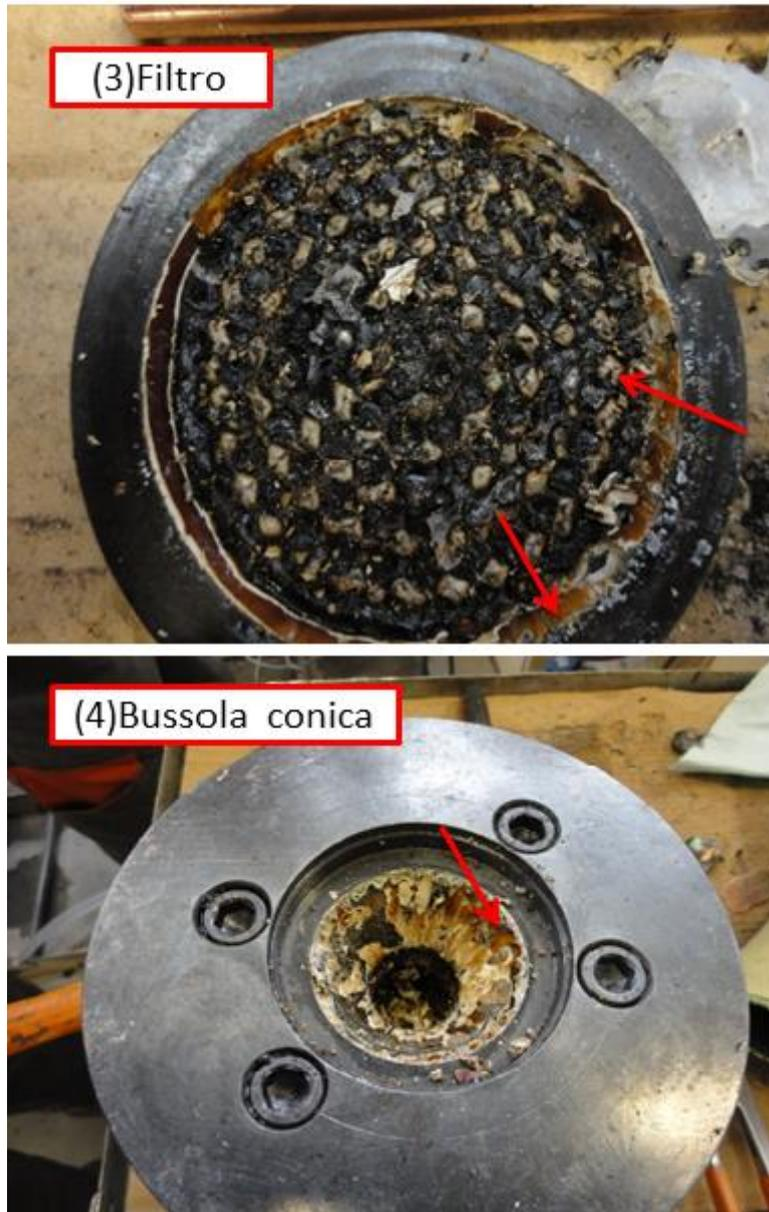
*Figura 4.2.8.: smontaggio della testa e analisi delle parti relative alla zona Clamp e alla bussola conica*
