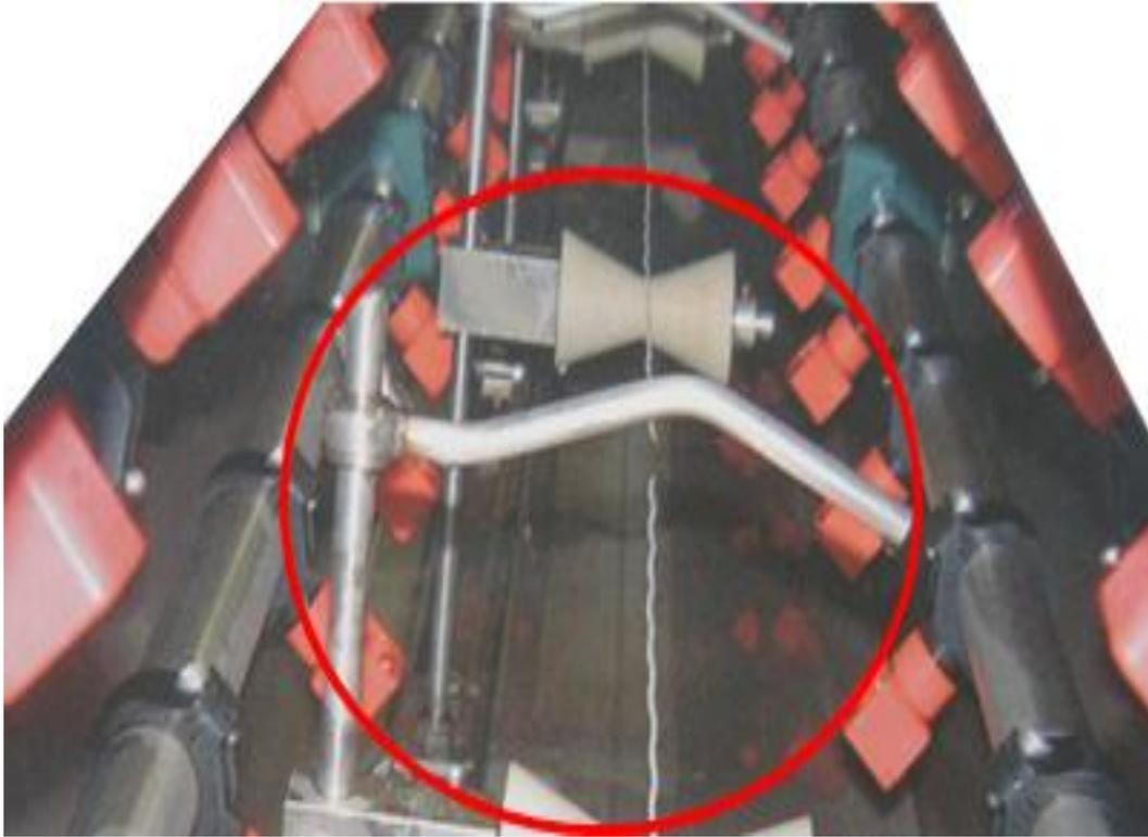
*Figura 4.2.5: linee guida che permettono il passaggio interno del tubo lineare*
