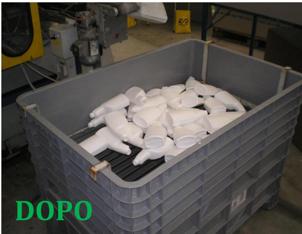
Il secondo problema riguardava la necessità di un meccanismo che consentisse la separazione delle materozze dai flaconi poiché come illustrato nella foto le precedenti condizioni di raccolta permettevano che le materozze deformassero i flaconi e potenzialmente si manteneva bassa l'individuazione delle difettosità sui flaconi. La soluzione è stata raggiunta attraverso l'utilizzo di griglie che consentono una separazione.
