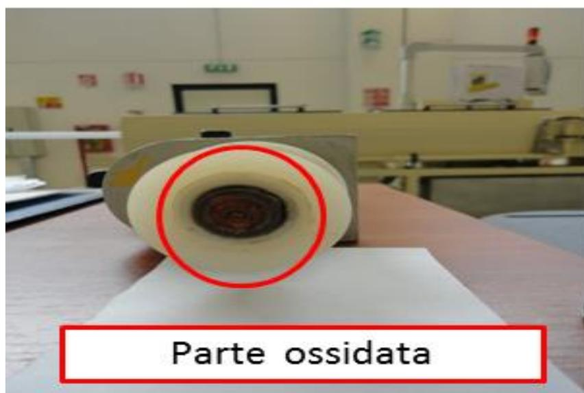
*Figura 4.2.2: Sostituzione della valvola per il vuoto in seguito all'ossidazione*
