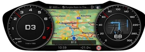
importanti. Audi virtual cockpit combina le funzioni dello schermo centrale MMI con quelle della strumentazione tradizionale in un unico, ampio display TFT da 12,3 pollici. Tutte le applicazioni e i servizi utilizzano un’eccezionale grafica con look 3D ed effetti ricchi di dettagli. Inoltre, il conducente può scegliere tra due visualizzazioni: la vista classica o la "modalità infotainment".
