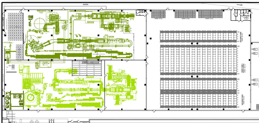
Figura 11 Layout produttivo degli impianti in corso di realizzazione (Fonte: Acqua Minerale San Benedetto S.p.A, 2017).
