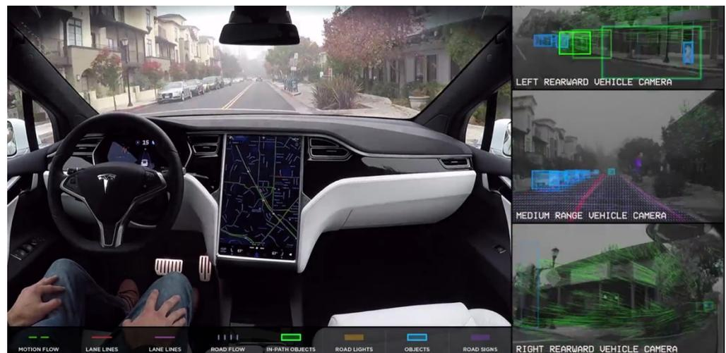
*Figura 38 Decostruzione 3D dell'ambiente circostante, con identificazione di ogni oggetto, segnaletica sia orizzontale che verticale.*
