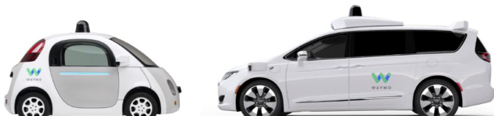
Figura 34 A sinistra la “FireFly” utilizzata nella fase iniziale di testing per la guida completamente autonoma. Sulla destra invece il SUV Chrysler Pacifica con l’attrezzatura della guida autonoma a firma Waymo
