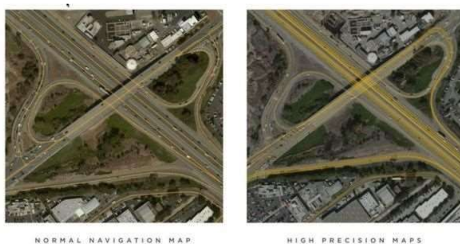
Figura 12- Differenza tra mappe di navigazione standard e mappe ad alta precisione per veicoli senza conducente.
