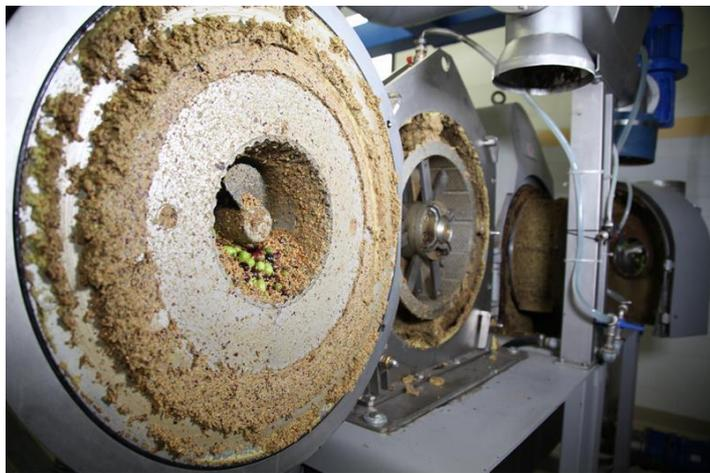
Con questo sistema la rottura della polpa è causata dagli urti dei dispositivi ruotanti ad alta velocità e solo in parte dall'azione meccanica dei frammenti di nocciolo.
