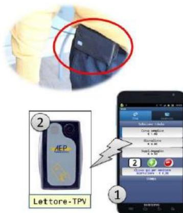
**Dispositivo portatile per leggere le tessere RFID e validare i Tickets elettronici**
