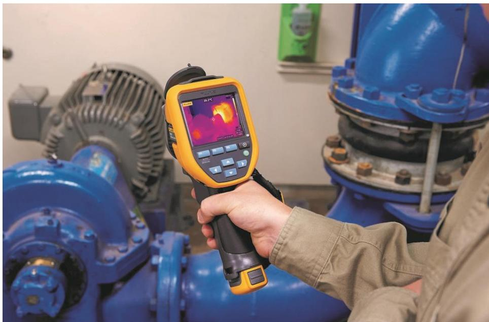
Fonte: <https://www.iseweb.net>. Analizzatore di vibrazioni (a sinistra) e termografo (a destra) per la manutenzione predittiva. Tali dispositivi possono anche essere integrati nel sistema primario e, collegati a una centralina o *electronic control unit* (ECU) in rete con un sistema di telecomunicazioni, trasmettono direttamente i dati a distanza presso una sala di controllo, senza la necessità della presenza di un operatore per testare lo stato di efficienza del bene.
