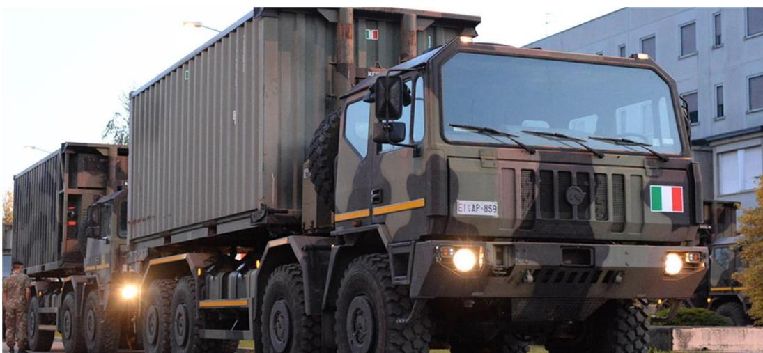
Fonte: Circ. 4004<sup>91</sup> del Comando Logistico dell'Esercito Ed. 2017. Il trasporto intermodale (autocarro, aereo, nave e treno) su container standard ottimizza la *supply chain* e, grazie a dispositivi RFDI, si integra in una rete di *track and trace*. Nella figura, un container da 20' imbarcato su un autocarro a pianale scarrabile dell'Esercito, l'APS-95.
