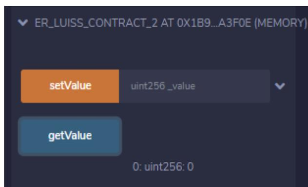
Possiamo vedere come, non avendo impostato alcun tipo di valore, di default mi appare 0. Mi viene fornito un uint256 perché, avendo scritto nella funzione solo uint, in automatico mi si imposta su un uint a 256 bytes. Ora inserisco invece un valore su setValue nello spazio in cui si può scrivere; metto un numero casuale intero positivo, per esempio 7, e clicco su setValue.
