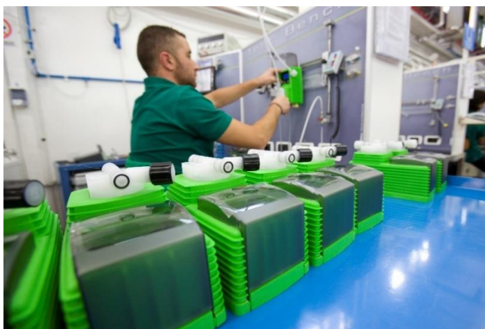
Fig. 3.4 Collaudo di una pompa dosatrice elettromagnetica (VMS MF)
