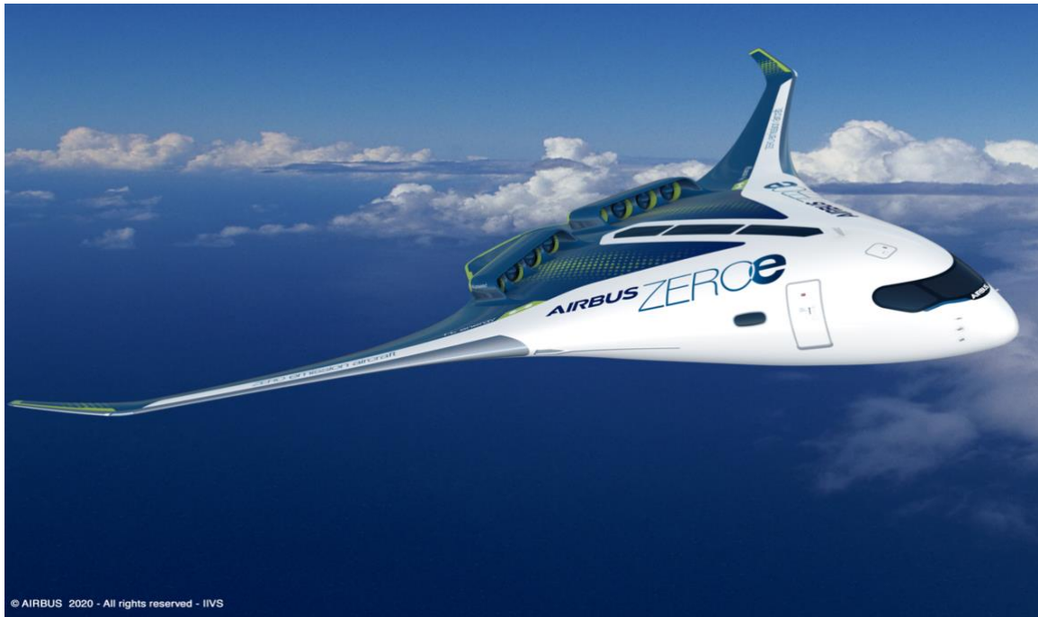
Figura 23 61 Lo ZEROe Blended Wing Body Concept ad idrogeno di Airbus
