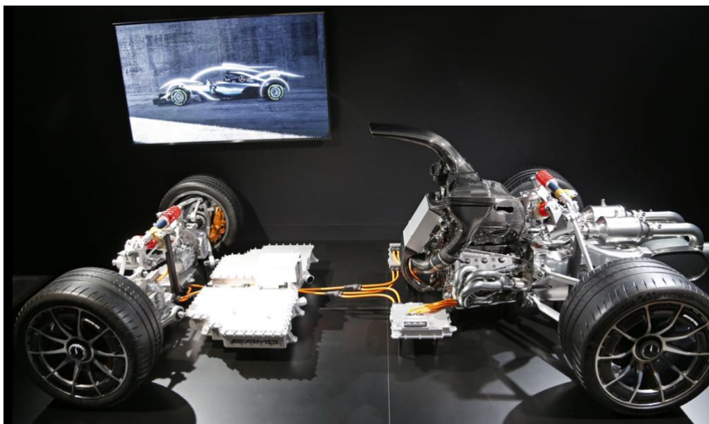
Figura 15 43 Powertrain di derivazione F1, Mercedes-Benz Project One
