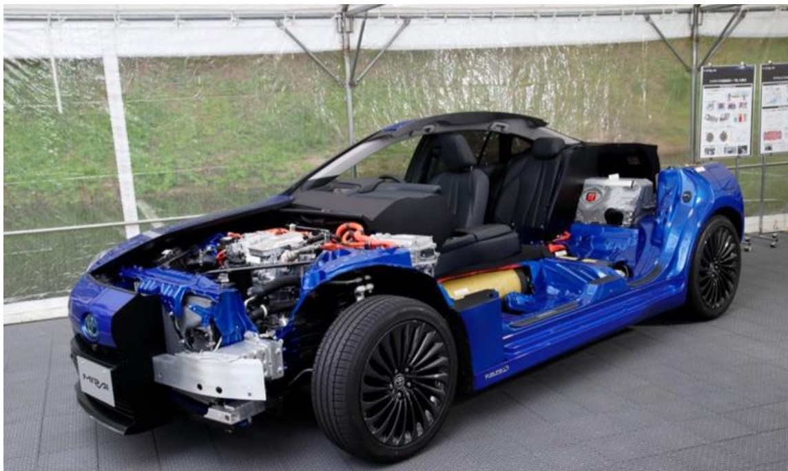
Figura 22 59 Chassis e sistema di alimentazione ad idrogeno della Toyota Mirai
