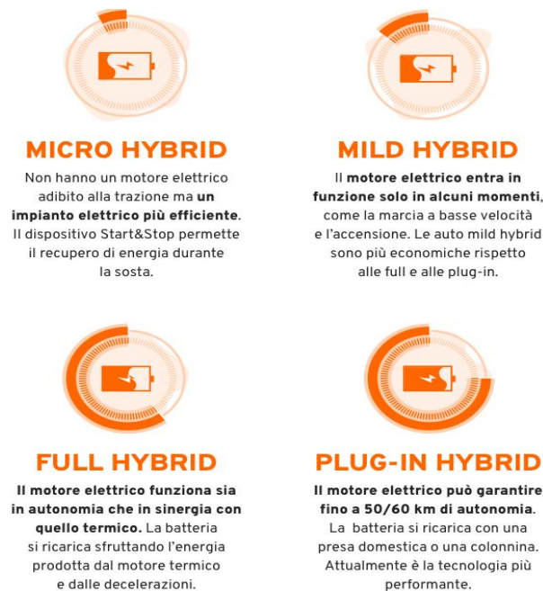
Figura 35.2 - tipologie di alimentazioni ibride Fonte: automobile.it, 2022
