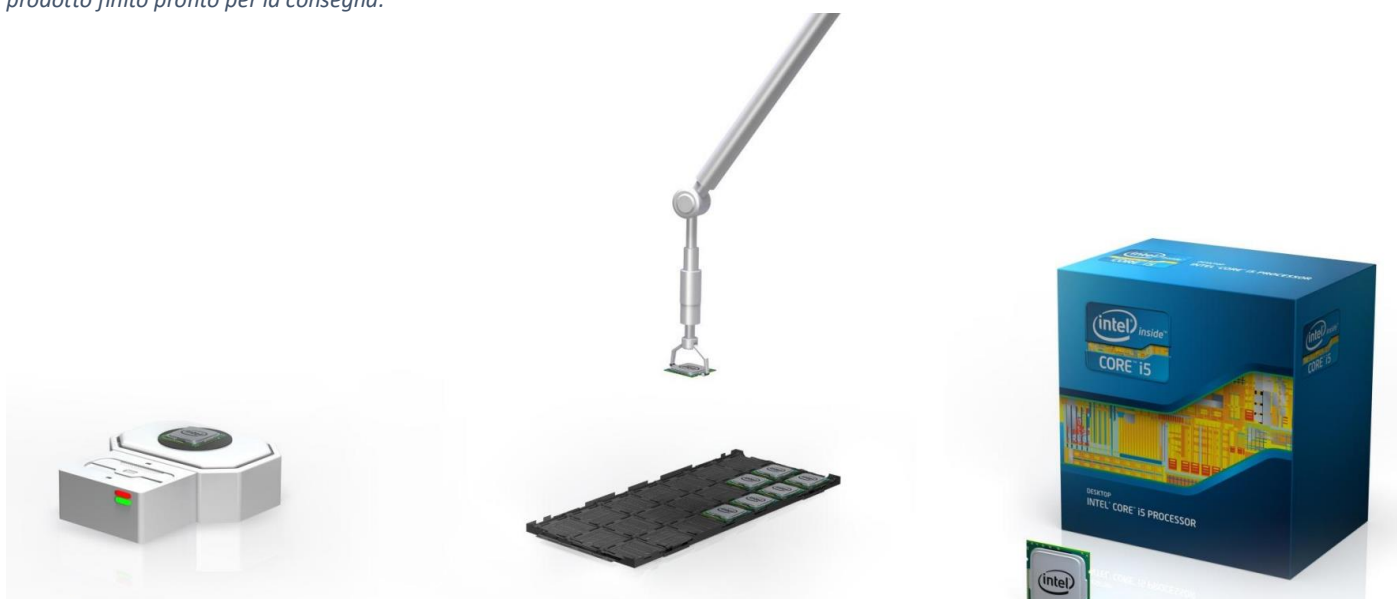
Figura 11 – Da sinistra verso destra: il chip viene nuovamente testato singolarmente; chip con le stesse caratteristiche vengono raggruppati; prodotto finito pronto per la consegna.
