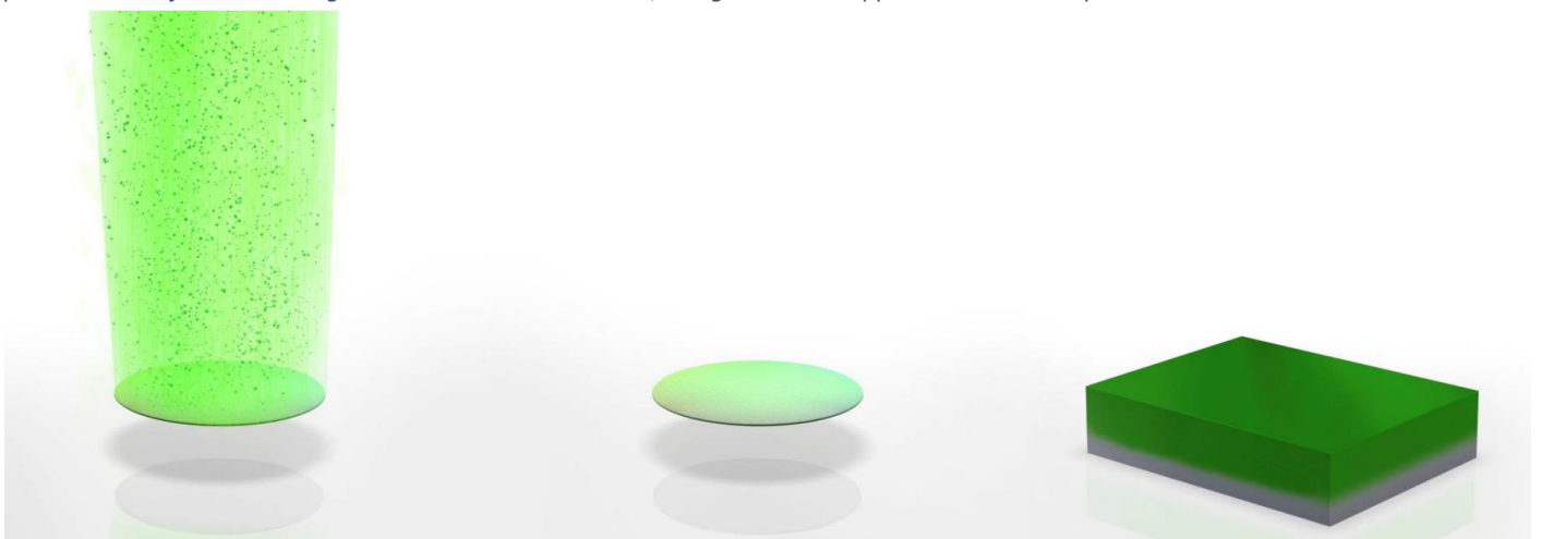
Figura 4 – Da sinistra verso destra: impiantazione ionica; rimozione del fotoresistente; l’ultima immagine sulla destra rappresenta una piccola porzione del wafer dove un singolo transistor verrà realizzato, la regione verde rappresenta il silicio dopato.
