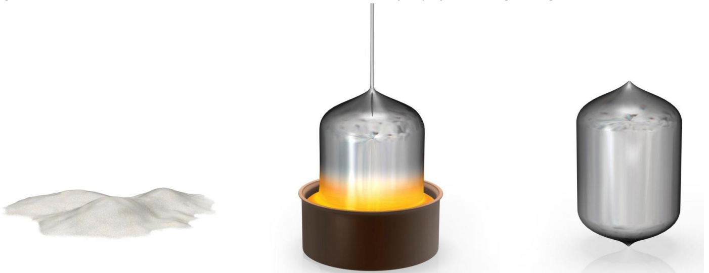
Figura 1 – Da sinistra verso destra: la sabbia da cui si ricava il silicio; il silicio viene fuso per formare il lingotto; lingotto monocristallino di silicio.
