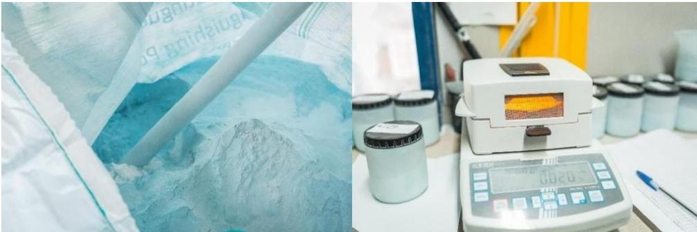
Il laboratorio interno analizza le concentrazioni delle componenti della polvere dopo aver rimosso tutta l’umidità contenuta nel campione. I dati raccolti sulla polvere in ingresso sono utilizzati dal responsabile della produzione per pianificare le lavorazioni.
