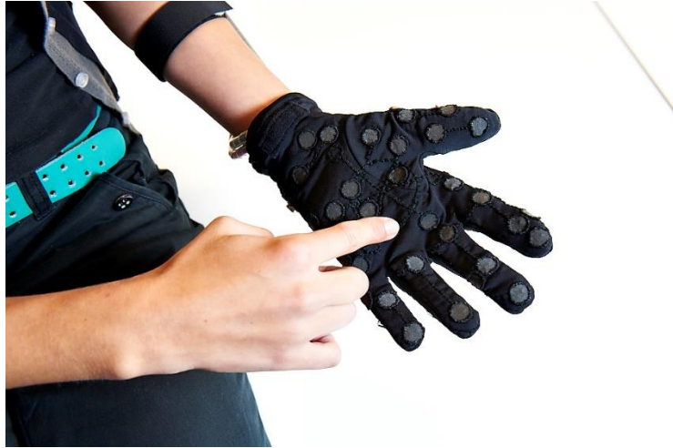
Figura n.5: Mobile Lorm Glove
