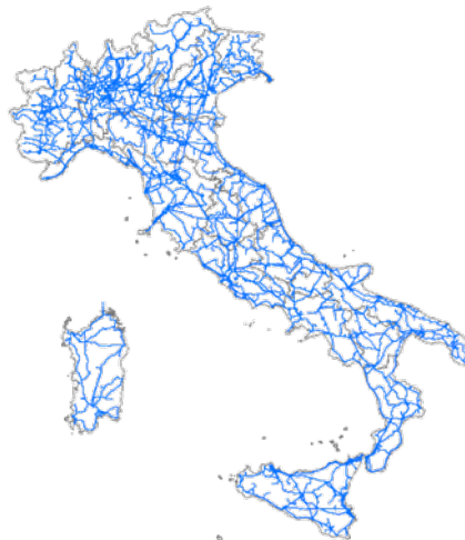
Figura 5 – Rete di subtrasmissione 132-150 kV
