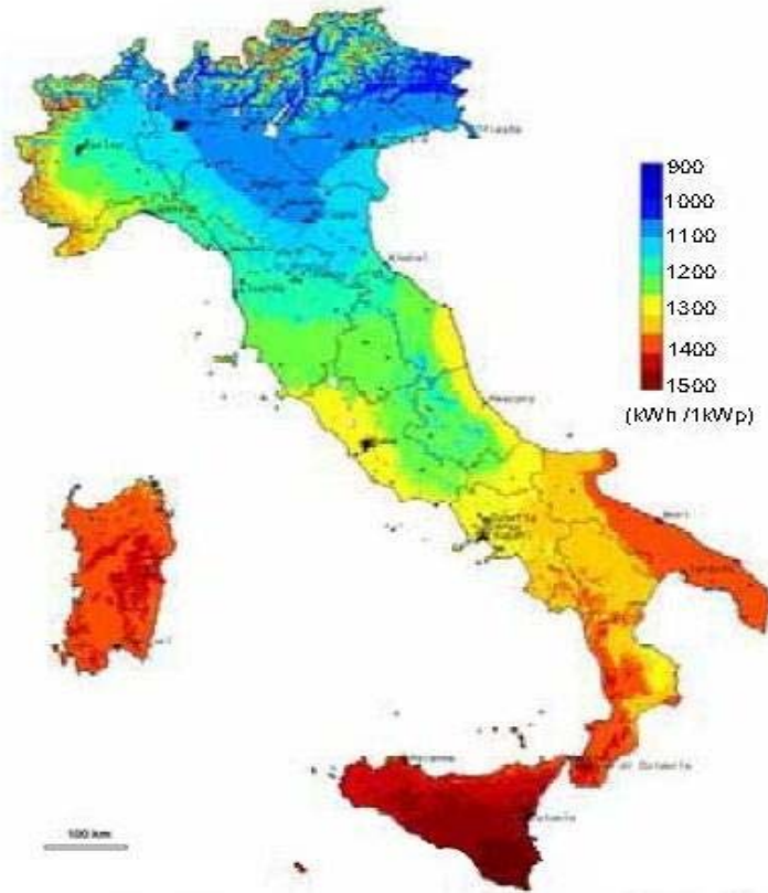
Figura 15 29 Produttività annuale per kWp installato, con inclinazione dei moduli ottimale.
