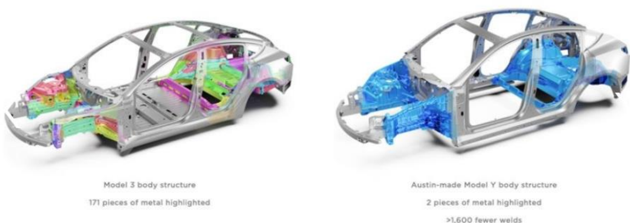
Figura 19: Riduzione delle Parti Strutturali: Confronto tra la Tesla Model 3 e la Model Y. Elaborazione estratta da https://www.alvolante.it/da_sapere/tecnologia/cos-e-il-mega-casting-e-perche-cambiera-il-modo-fare-auto-385277
