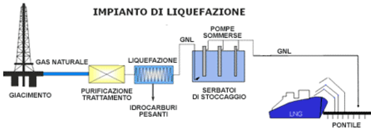
Figura 11: Impianto di liquefazione
