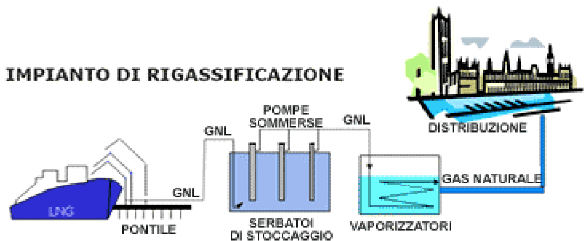
Figura 1.7: Impianto di rigassificazione
