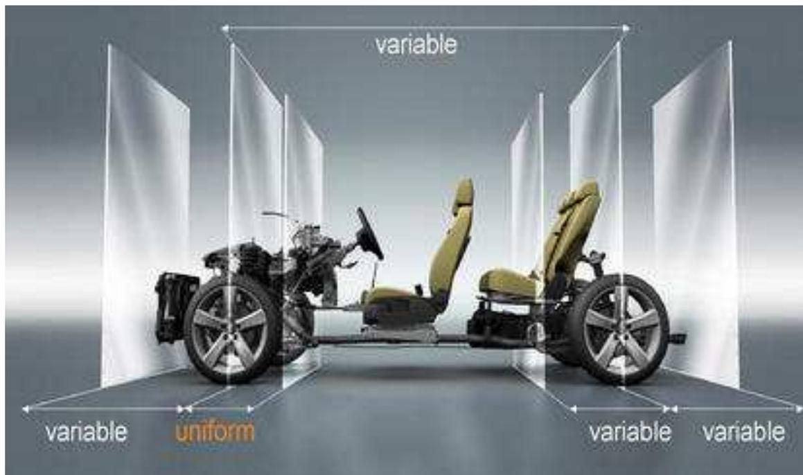
Figura 4 – Con la piattaforma MQB, soltanto la posizione del motore e la distanza tra l'asse anteriore ed i pedali sono fissi. Virtualmente tutte le altre dimensioni sono variabili.
